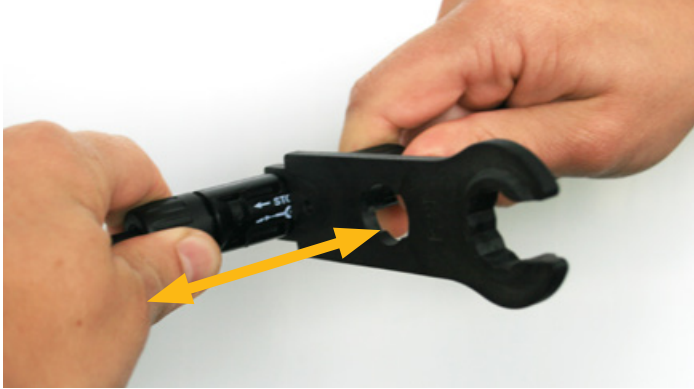
그림 4: 공구를 사용하여 MC4 타입 커넥터(Multi-Contact 또는 Hosiden) 분리하기
