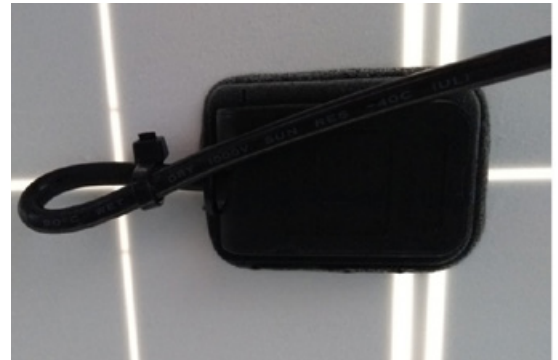
그림 9: 극단적인 각도로 정선박스에서 나오는 케이블의 예시
