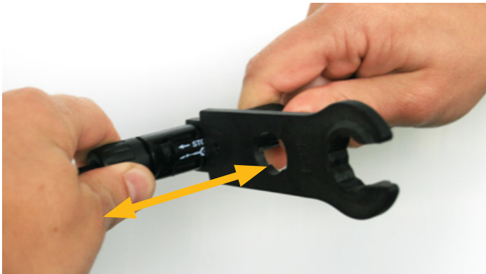
図4: MC4タイプコネクタの工具による切断(マルチコンタクト社製またはホシデン社製)
